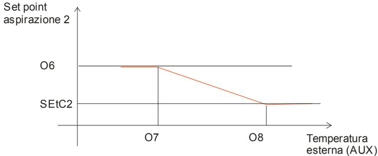
**7.1.18 Funzione set point dinamico per ottimizzazione temperatura di condensazione (o9-o14)**
