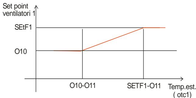
**NOTA:** nel caso in cui C45 = bar o PSI o KPA, O10 viene espresso in bar o PSI, l'XC1000D provvede a fare le necessarie conversioni.
