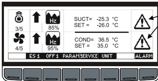
Se i simboli di allarme stanno lampeggiando sulla schermata principale, significa che si sta verificando un allarme.
