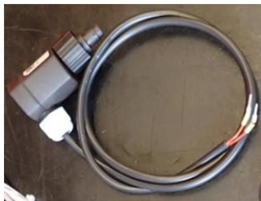
Rysunek 4: Elektroniczna część czujnika różnicy ciśnienia oleju OPS3 (dostarczona podłączona)
