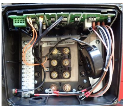
Rysunek 3: Widok modułu NGCS bez pokrywy
