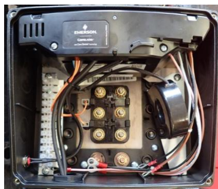
Rysunek 2: Widok puszek zaciskowej bez pokrywy
