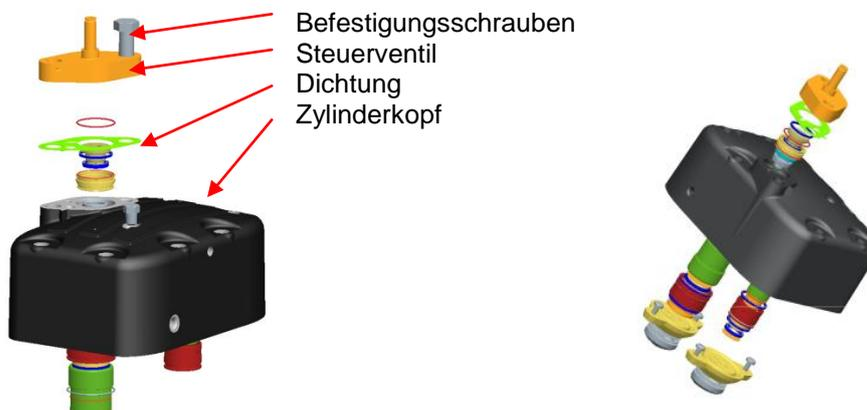
**Bild 11: Aufbau des digitalen Zylinderkopfes**
