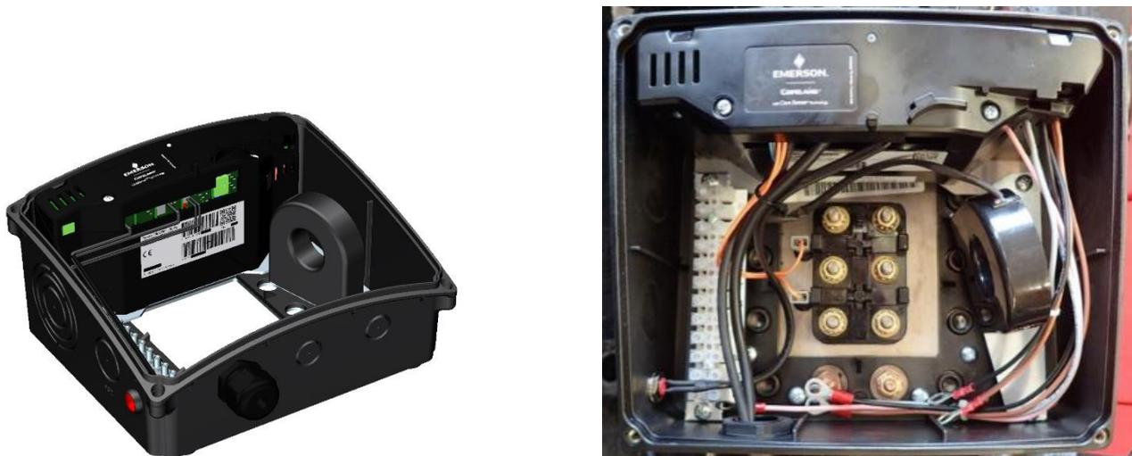
Figure 6 : Boîtier électrique avec module Copeland Compressor Electronics
