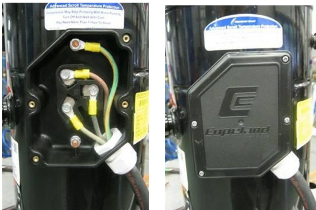
Figure 20 : Installation correcte avec presse-étoupe, boîtier électrique en IP54
