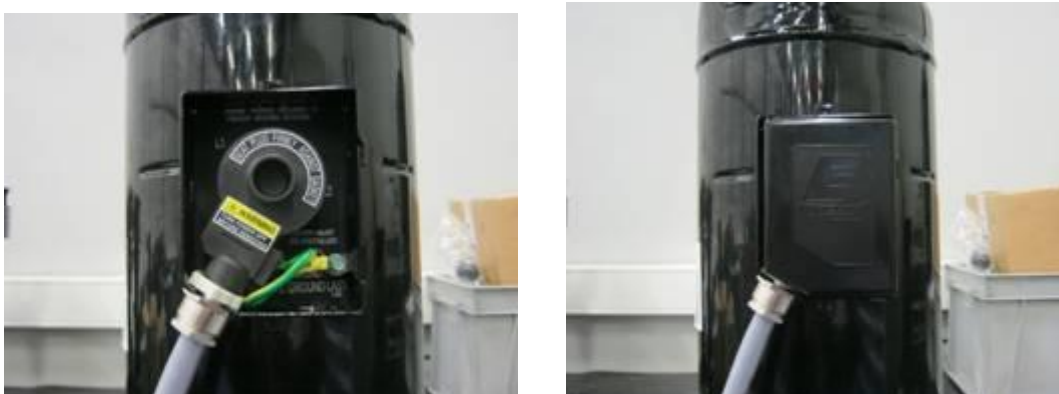
Figure 21 : Installation correcte avec presse-étoupe, boîtier électrique en IP66
