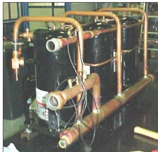
Рис. 4: Конструкция всасывающего коллектора
